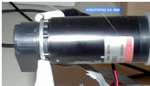
Σχήμα 6-5. Κινητήρας συνεχούς ρεύματος, 48 Volts, 70 Watt της MAXON MOTORS.
